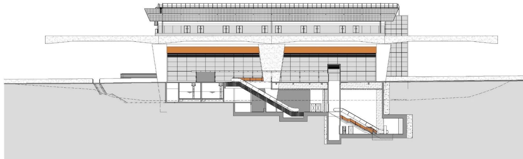
Figura 4-CORTE LONGITUDINAL DO CORPO DA ESTAÇÃO PASSANDO PELAS ESCADAS DE ACESSO AO TÚNEL DE INTERLIGAÇÃO
